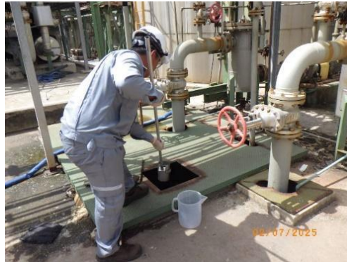
บ่อตรวจสอบคุณภาพน้ำเสียของโรงงาน ก่อนส่งเข้าระบบบำบัดน้ำเสียของโรงงานผลิตสารคาโปรแลกตัม (Influent)
